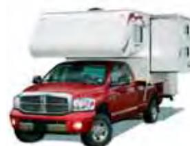
Ici, la partie habitable est montée sur le pont d'une camionnette et n'est pas accessible depuis la cabine de conduite. Quelques-uns sont même équipés d'un espace extensible (Slide-Out). Se prête bien à l'exploration du Canada septentrional et de l'Alaska. Consommation d'essence: 15-28 l/100 km.
